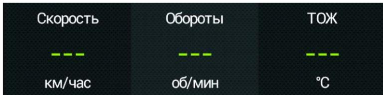
4. Если на экране мобильного устройства длительное время не показываются параметры "Скорость", "Обороты", "Температура охлаждающей жидкости", значит в автоматическом режиме протокол определить не удалось, требуется установить его вручную: заглушите двигатель автомобиля, выключите зажигание и произведите настройки МК:
