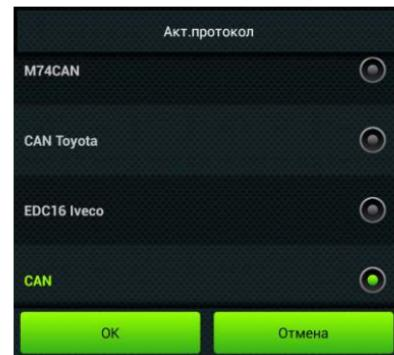
5. Необходимо проверить правильность выбора протокола: завести двигатель, выйти в главный экран, нажать кнопку “Параметры” и проверить корректность следующих параметров: обороты, температура охлаждающей жидкости двигателя.
