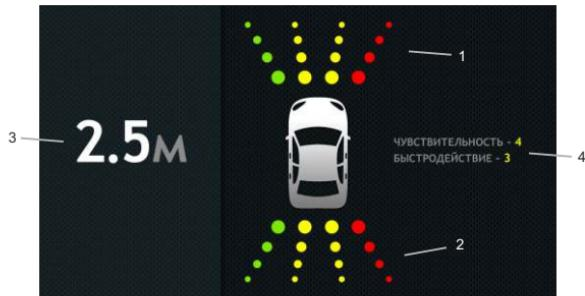
При включении парктроника экран переключается в режим “Парковка” (при подключенном парковочном радаре Multitronics - опция).
