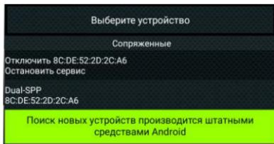
**Остановить сервис** - прекращение работы программы: остановка работы сервиса, отключение от МК. МК продолжает работать с автомобилем в автономном режиме. MAC-адрес показывает, с каким МК программа работает в текущий момент.
